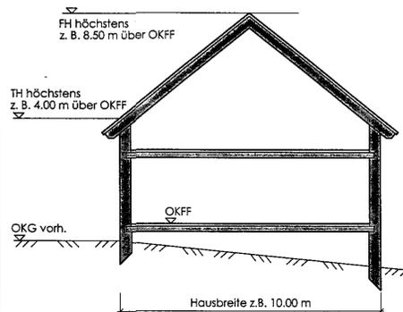
OKFF Oberkante Fertigfußboden Erdgeschoss
